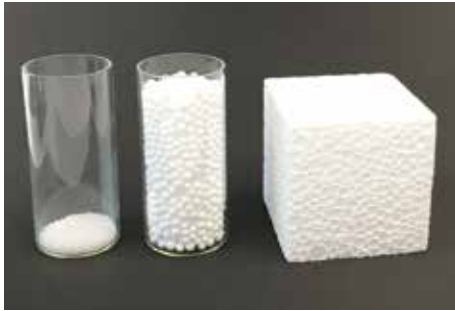
Das Vorschäumen von PS-Mikrogranulat (links) und das Verschweißen der Schaumperlen (Mitte, gleiche Masse) zum EPS-Formteil erfolgt bis dato mit Wasserdampf (© NMB)
