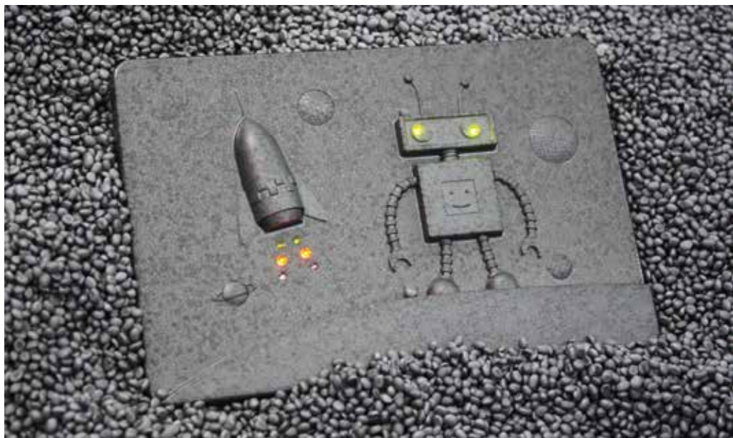
Dampffrei produzierter EPS-Demonstrator („Filli Future“) mit \mu -genauer Oberflächenstrukturierung, rückseitigem PS-Foliendekor sowie schonend umschäumter Funktionseinheit mit Neodymmagneten, LED-Array, Steuerungsplatine und induktiver Ladeschleife (© FOX Velution/B. Girg)
