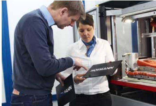
Werkzeugfallender Leichtbau mit Partikelschäumen: Jörg Vetter und Mirjam Lucht, geschäftsführende Gesellschafter von FOX Velution, mit Sandwichplatten, die in einem dynamisch temperierten Formschaumwerkzeug (rechts) gefertigt wurden
